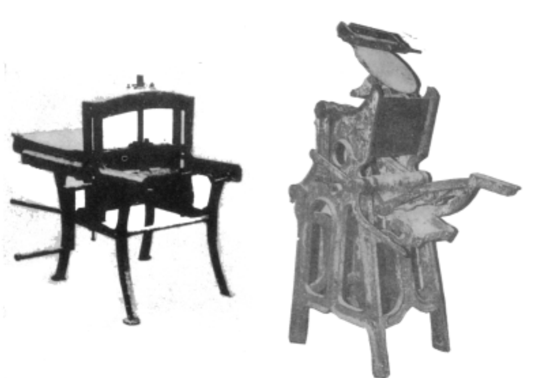
圖 15-7 建設銀行印鈔廠使用的圓盤機和石印機
