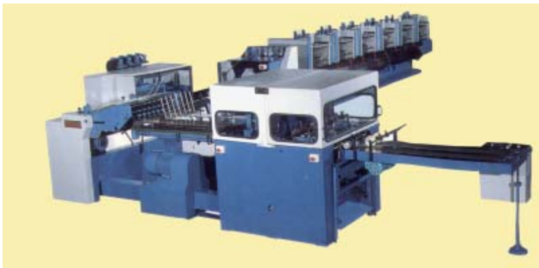
圖 25-8 上海紫光機械有限公司（原上海訂書機械廠）生產的 LQD8E 騎馬訂聯動機
