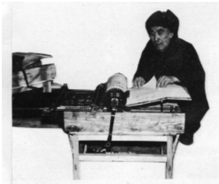
圖 15-4 牛步峰和他研製的木質輕便鉛印機
