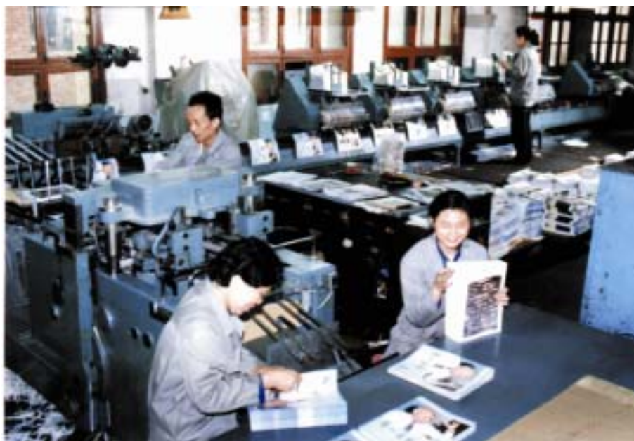
圖 19-16 貴州新華印刷廠裝訂車間騎馬訂聯動生產綫
