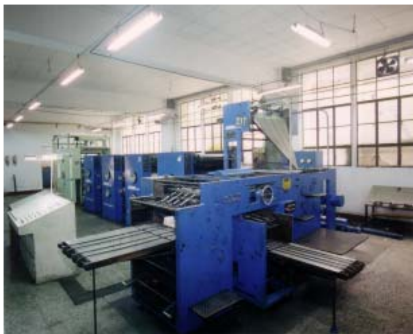
圖 20-1C 重慶新華印刷廠八色輪轉膠印機
