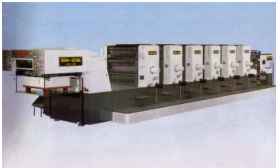
圖 26-7 新進鐵工廠生產的六色張頁紙平印機
