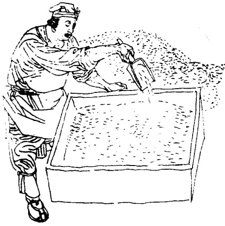
圖 7-12 在砂框內填入造型材料
