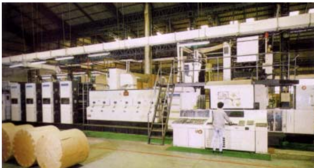
圖 26-5 秋雨印刷公司卷筒紙輪轉印刷機
