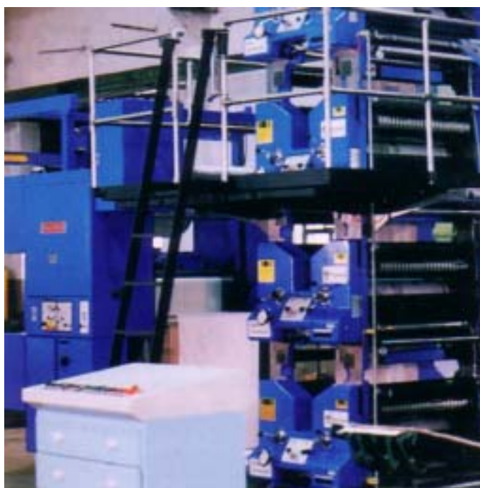
圖 25-7B 上海高斯印刷設備有限公司 (原上海人民機器廠) 生產的高速輪轉膠印機
