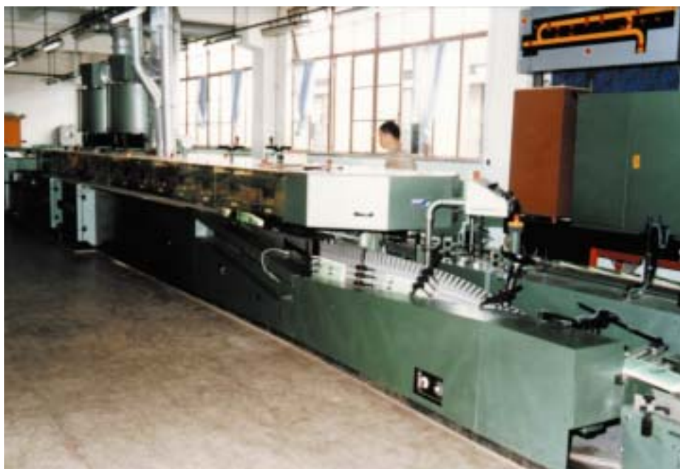
圖 19-17 商務印書館上海印刷廠引進的瑞士馬天尼膠訂聯動機
