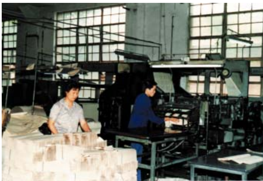
圖 25-6 西安新華印刷廠鉛印車間 LS201 型鉛印輪轉印刷機
