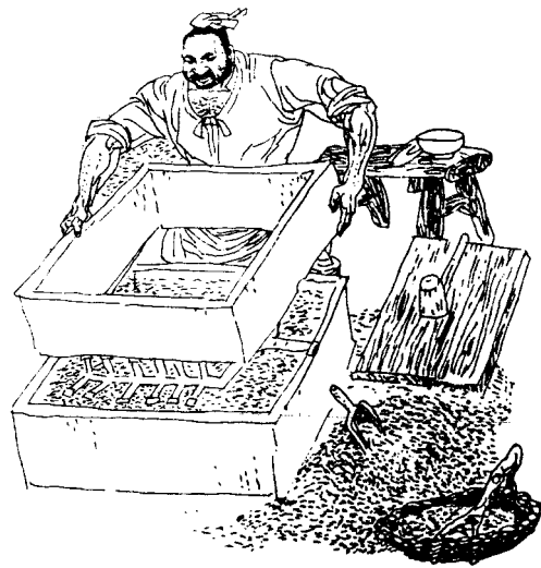
圖 7-15 放上第二個砂框並填入造型材料
