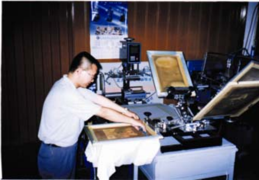
圖 19-13 絲網印刷製版顯影
